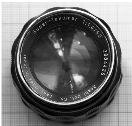
Il. 25. Obiektyw Super-Takumar 1,4/50 z soczewkami z domieszką toru-232, który polepszał parametry optyczne szkła: pozwalał osiągnąć wysoki współczynnik załamania światła przy zachowaniu niskiej dyspersji.
