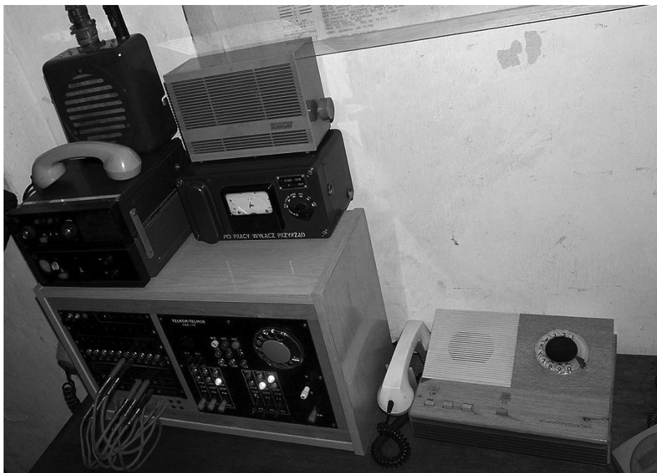
Il. 30. Łącznica telefoniczna, głośnik od radiowęzła i rentgenometr D-08 w Muzeum OC, 2017.
